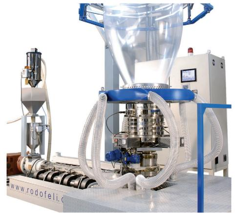
• Extrusoras de 90mm para 220cm de bobinado.
