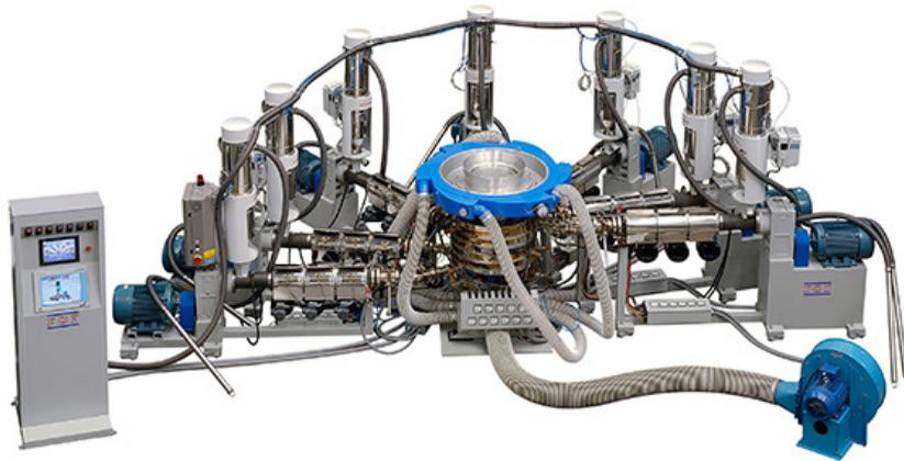
• Línea de coextrusión de 7 capas, para películas barreras.
